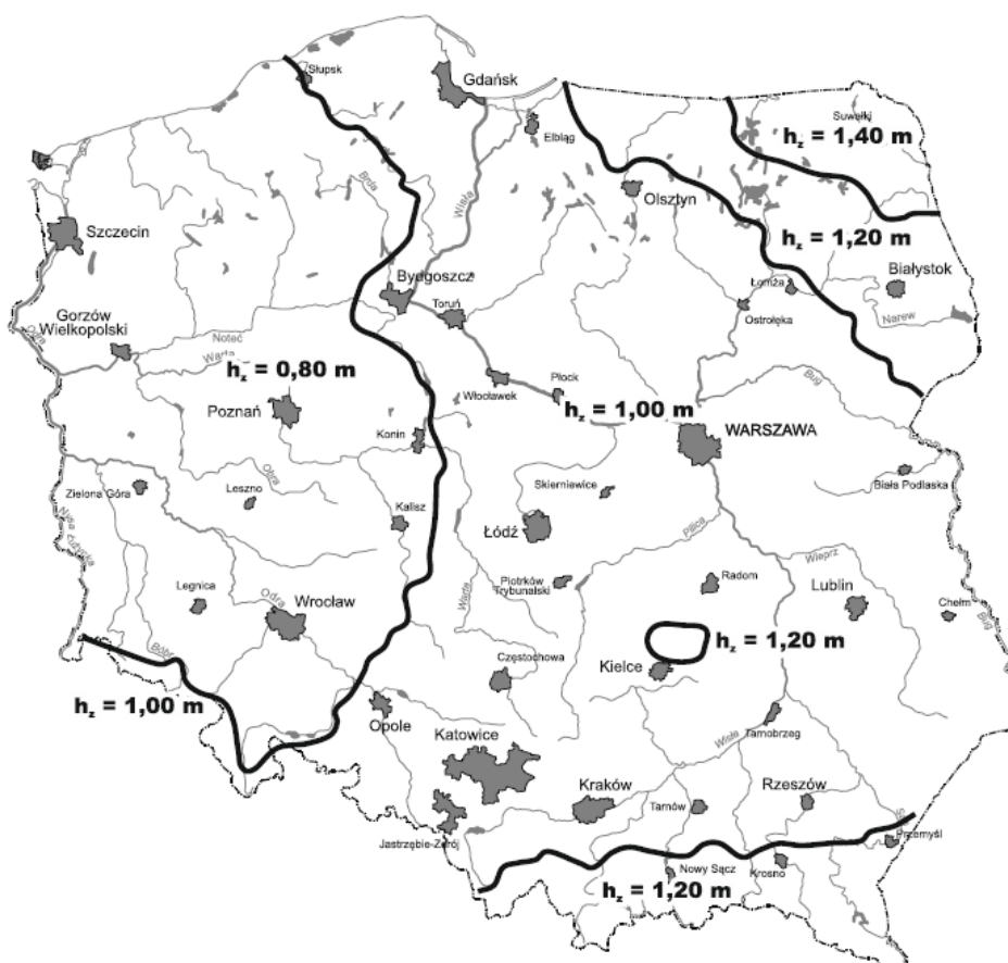
Rys. 10.1. Głębokość przemarzania gruntu h_z wg PN-81/B-03020
